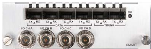
SMART 平面パネル 映像およびデータ I/O および 状態表示 LED
